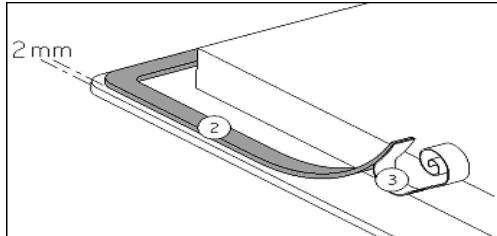
Fastgør tætningslisten (2) to millimeter fra glassesets yderkant – efter De har fjernet den beskyttende papiroverflade (3)
